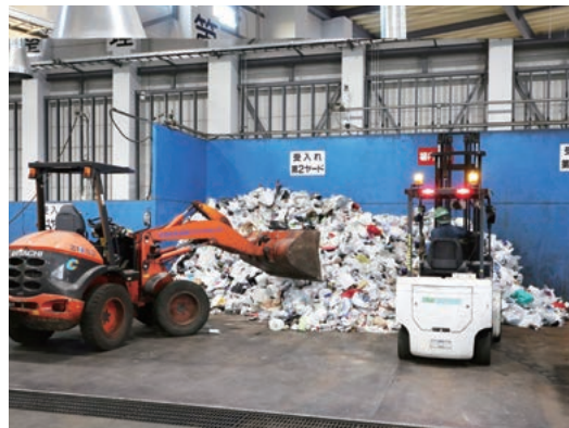
重機を用いて不燃ごみをコンベアへ
